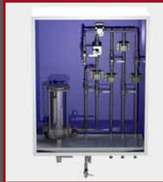
В случае взятия пробы из надземных резервуаров в составе системы отсутствует ручной насос. Отбор проб нефтепродуктов ведется из трех точек, а также возможен отбор смешанной пробы.
